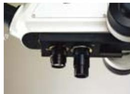
使用带有 2 个目镜安装槽的滑动型目镜转换盘选件 (工厂设置选件)
