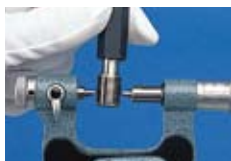
图为已安装好匹配的可更换选件测砧和心轴探针的 116-101
