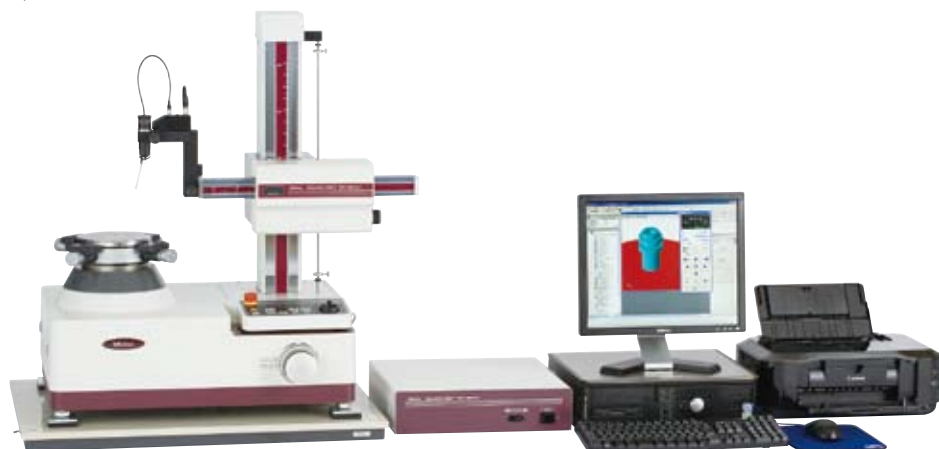
连接个人计算机系统和软件的 RA-1600
